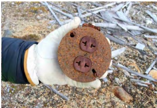
Fig 36. T-slot duplex stikkontakt med hus. Elnettet vil have kørt med den amerikanske forsyningsspænding på 110-120 V. (foto: H. Lange og H. Hansen 2018)
