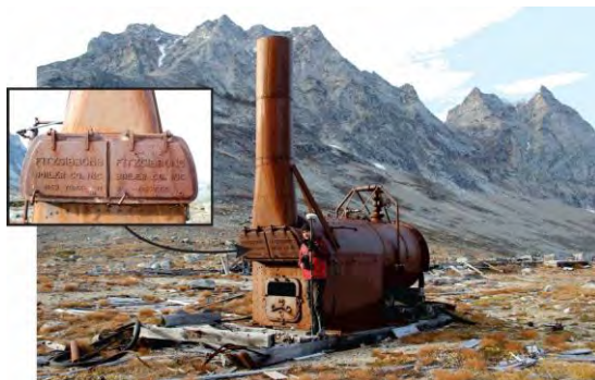
Fig. 39. En industriel kedel fremstillet af FitzGibbons Boiler Company, Inc., Oswego, New York. Harmsen, (foto: H. Lange 2018).
