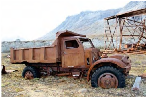
Fig 23. Sterling HC 145 lastbil, ca. 1940-41. 6-cylindret SRKR Waukesha-motor med benzin. (1)
