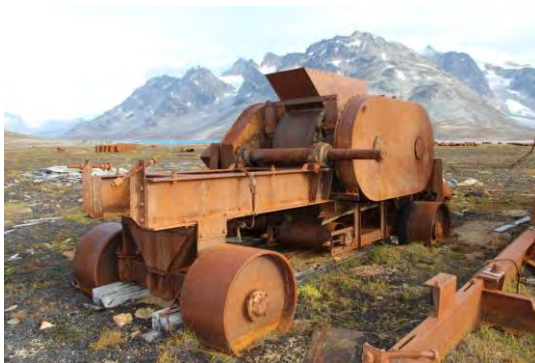
Fig. 38. Stemknuser bruges til at producere grus til landingsbanen ved Ikkatteq-BE2 (foto: H. Lange 2018).
