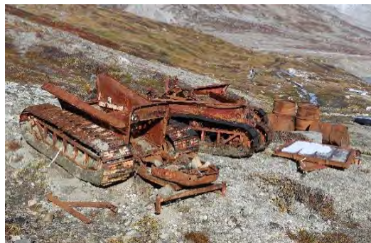
Fig 26. Rester af en Allis-Chalmers M-7 snetraktor. Disse små køretøjer blev brugt til redningsoperationer i fjerntliggende og snedækket terræn og er ekstremt sjældne WW2-relikvier. (1)
